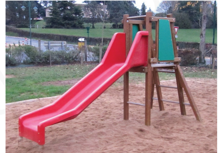
Hauteur de chute 900 mm
